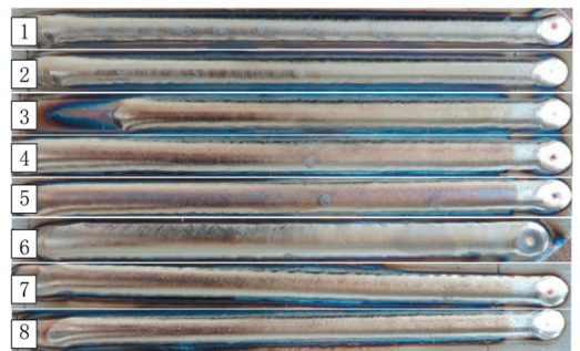
图3 预试验单道焊缝成型
